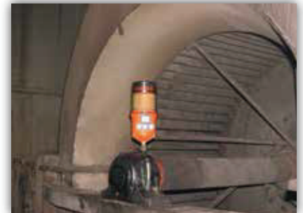
Grasera instalada en un ventilador de un soplador
