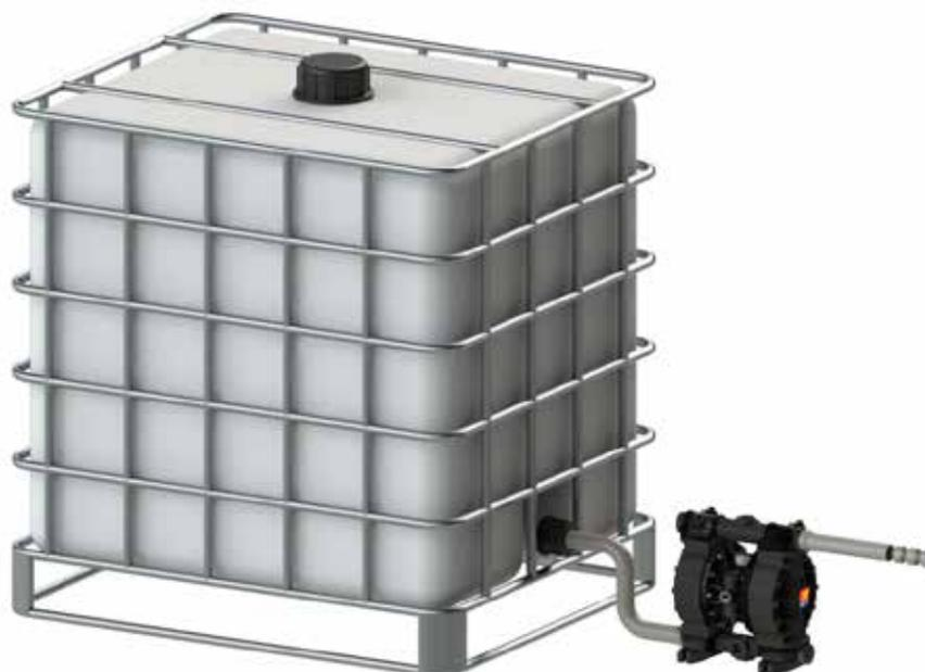
**Bomba instalada por debajo del nivel del fluido
