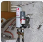
**La presión generada de 6 bares permite montaje a distancia de hasta 5 m**
